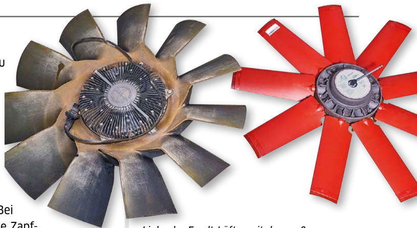
Links der Fendt-Lüfter mit der großen Visco-Kupplung. Rechts der Cleanfix mit Flügelwinkel-Verstellung.
