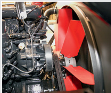
Die roten Flügel sind typisch für den Cleanfix, der über die Quer-Stellung umschaltet.
