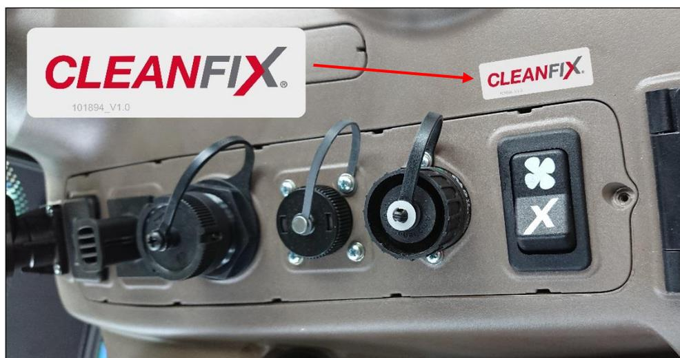
**6.1.7 Posa del tubo flessibile pneumatico della ventola reversibile Cleanfix® verso la valvola Cleanfix®**
