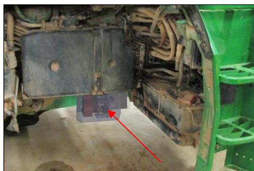
Para fixação é possível usar os pontos destinados para o sistema de ar comprimido.
