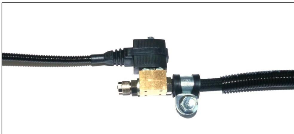
**6.1.4 Montando a mangueira de pressão do reservatório de ar comprimido na válvula**
