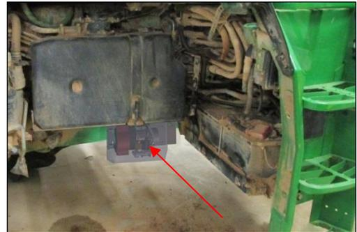
Zur Befestigung können die Befestigungspunkte genutzt werden, die für die Druckluftanlage vorgesehen sind.
