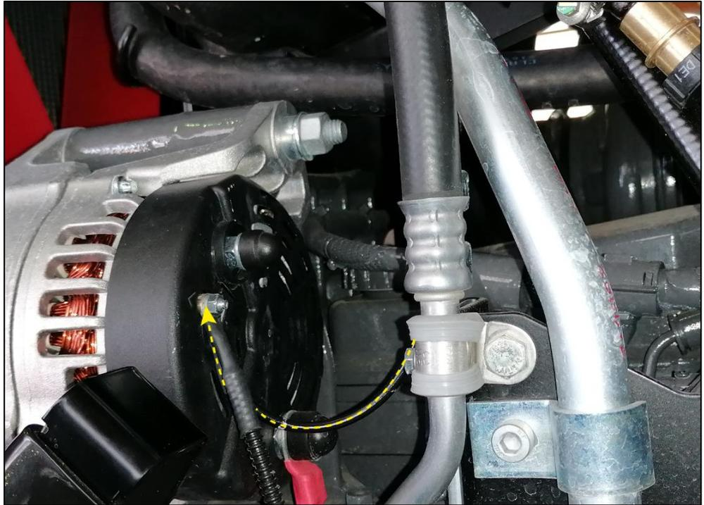
**HINWEIS****Sachschäden durch Anliegen des Wellrohrs an heiße Leitungen!**
