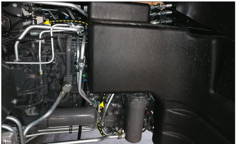
**HINWEIS****Sachschäden und Undichtigkeit durch Anliegen des Überströmventil an Bauteilen!**
