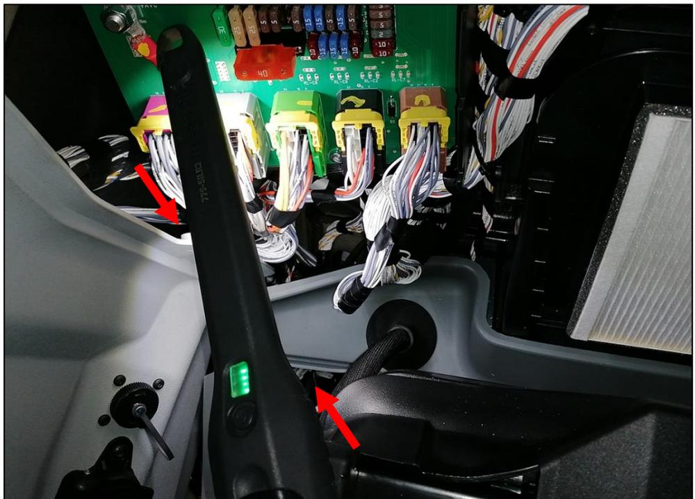
Stopfen für Kabeldurchführung: Ansicht von der Kabinen Innenseite hinten rechts
