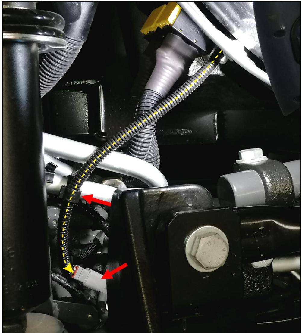
**HINWEIS****Sachschäden durch Anliegen des Wellrohrs an heiße Leitungen!**
